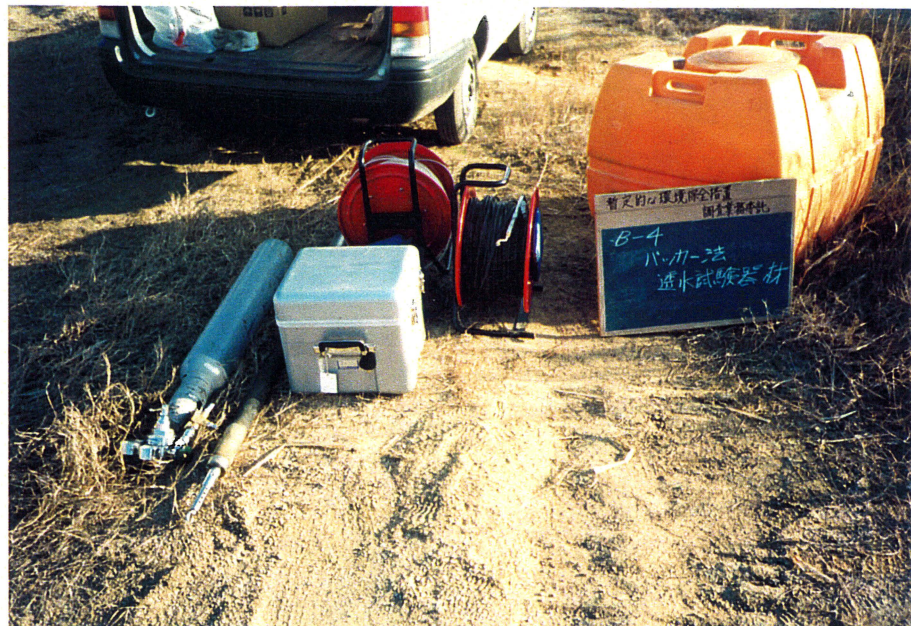
現場透水試験(パッカー法)器材状況
